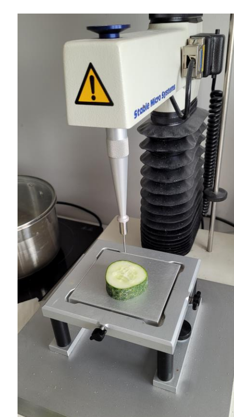
Ryc. 4 Pomiar tekstury na urządzeniu TA.XT plus Texture Analyser (Stable Micro System Ltd., Surrey, UK)
